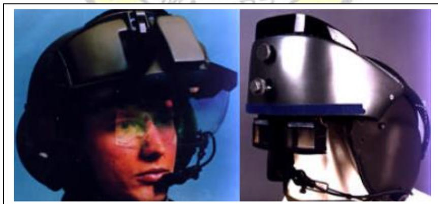
Gambar 2.8 Contoh *see-through* HMD, dibuat oleh Hughes Electronics (Azuma 1997)
