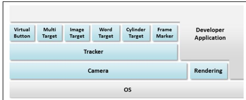
Gambar 2.19 Gambaran sistem tingkat tinggi dari Vuforia SDK (Qualcomm Vuforia Developer Portal, 2011)
