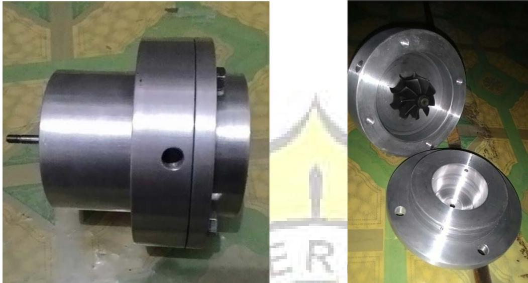
**GAMBAR 9 BLADE DAN PENUTUP TURBIN**
