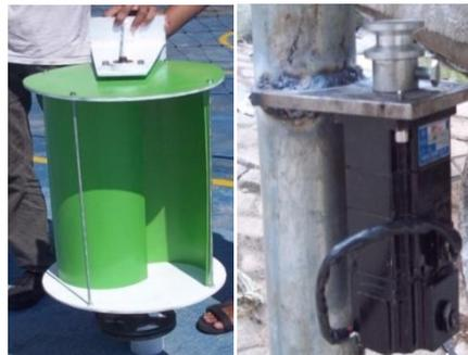
**Gambar 7.** Turbin Savonius dan Generator
