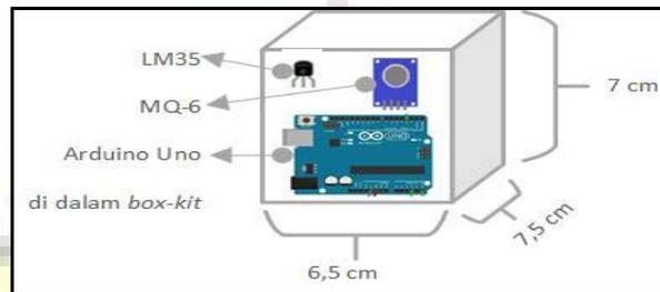
**Gambar 3.3** Prototipe Sistem
