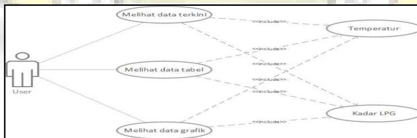
Gambar 3.1 Use Case Diagram Aplikasi Monitoring
