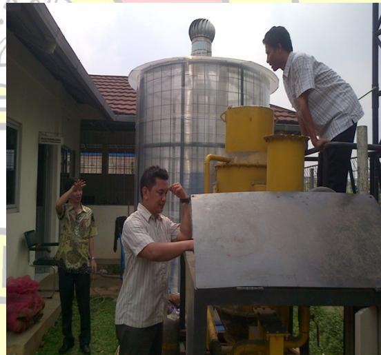
Gambar 4. Percobaan alat gasifikasi dengan bahan bakar tempurung kelapa
