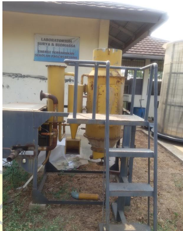
Gambar 3. Alat gasifikasi yang dibuat
