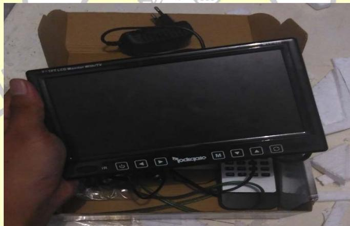
Gambar 5. Monitor mobil yang dipakai untuk melihat hasil sensor ROV rancangan
