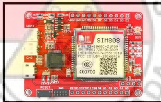
**Gambar 7.** Modul SIM808 Sumber gambar : forum.arduino.cc
