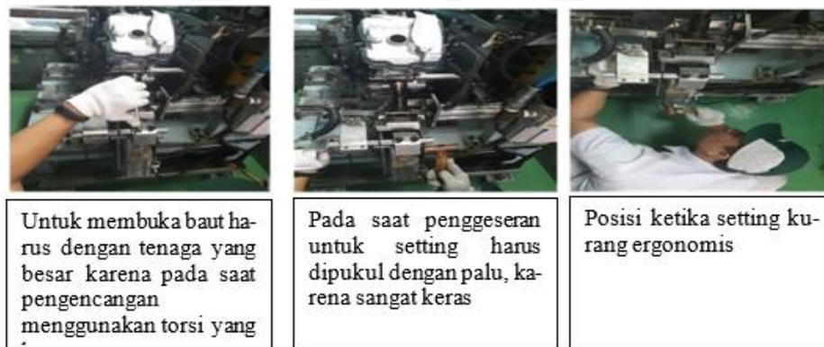
Gambar 6. Proses Pengecekan *Engine Noise* sebelum perbaikan *Muffler*.
