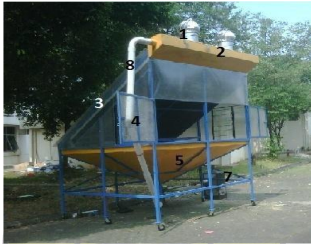
Gambar 6. Diagram skematis pengering surya hibrida ICDC tipe resirkulasi. 1). Vortekx, 2). Distributor, 3). Ruang pengering ICDC, 4). Konveyor pneumatik, 5). Bak penampung, 7). Tungku pemanas. (Kamaruddin dkk, 2011)
