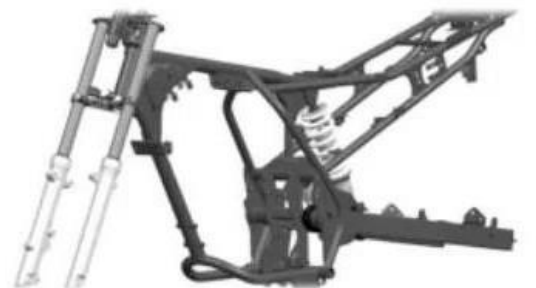
Gambar 2. 3 Rangka Bak Semi Tunggal (6).
