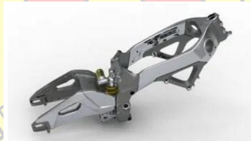
Gambar 2. 8 Rangka Balok Penyeimbang (6).
