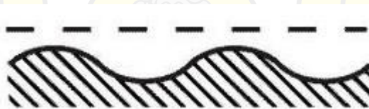
Gambar 2.7 Tingkat 2 ketidakrataan permukaan (Dasar metodologi industri, Hal: 224).
