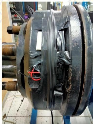
**Gambar 4. 2** Generator termoelektrik ditempelkan pada sisi roda
