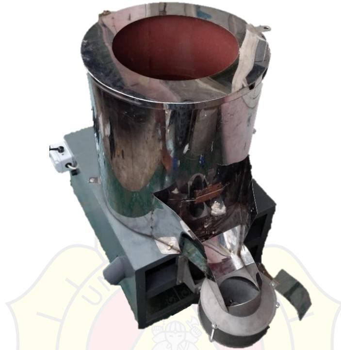
**Gambar 4.9** Mesin pengupas dan pemotong kentang
