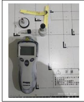
Gambar 3. Alat ukur RPM
