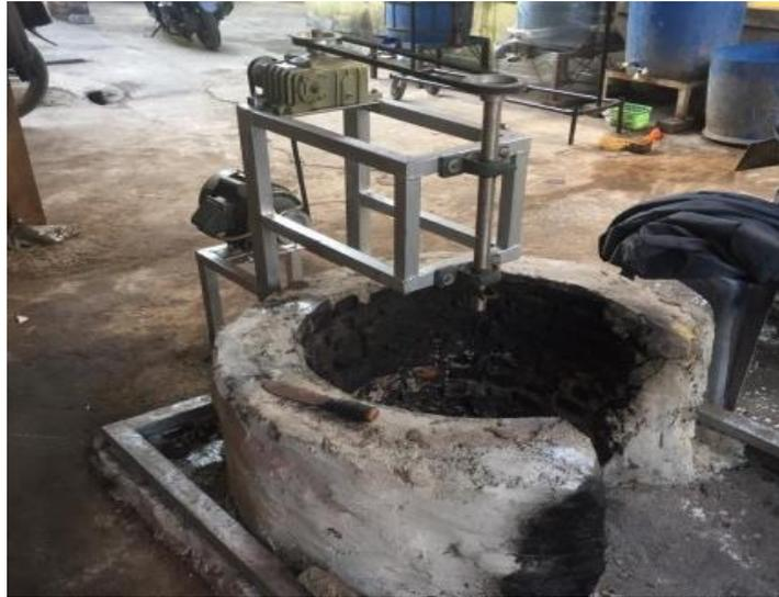
Gambar 4.1. Mesin pengering hybrid untuk jenang dodol.
