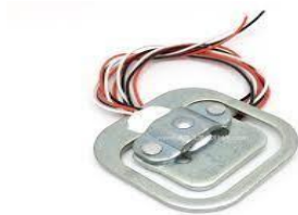
Gambar 2. 12 Bentuk fisik sensor berat ( load cell )
