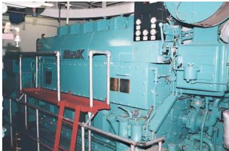
(Gambar I.5: Mesin penggerak utama)
