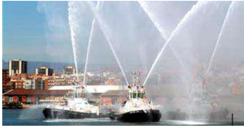
Gambar 2.3: kapal yang menngunakan 2 fire monitor
