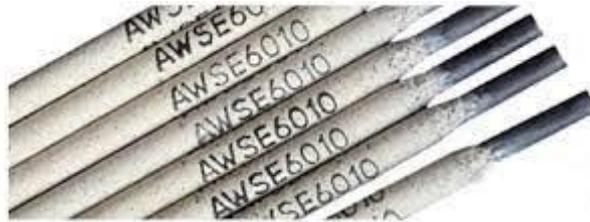
*Gambar 2. 25 Elektroda E6010*
