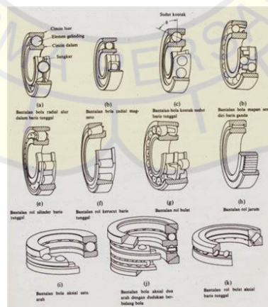
Gambar 2. 7 Bantalan Gelinding Khusus (Sumber: Sularso, 1978)
