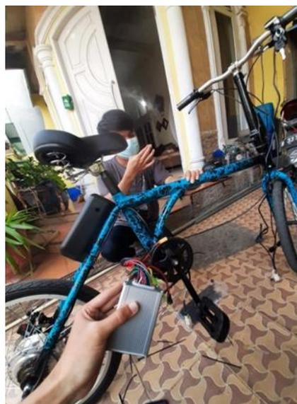
GAMBAR 9. Perakitan komponen sepeda listrik
