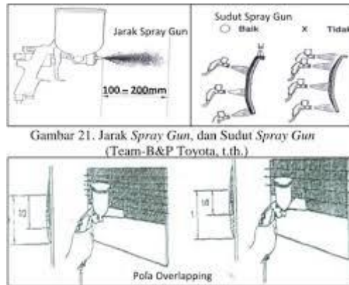
Gambar 2.1. Jarak Spray Gun , dan Sudut Spray Gun (Team-B&P Toyota, t.th.)
