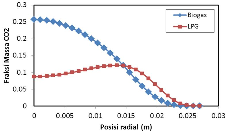
Gambar 7. Plot fraksi massa CO<sub>2</sub> di sisi keluar arah radial dari sumbu.
