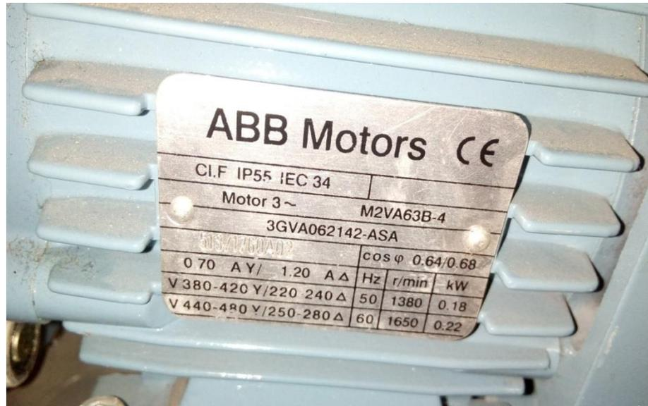
Gambar 3.1 Spesifikasi Motor Induksi 3 Fasa yang Digunakan
