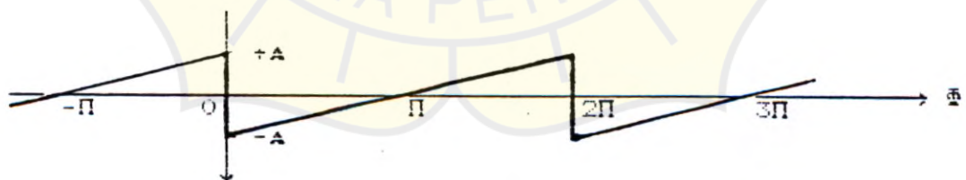
gambar 2.12 Sinyal Keluaran Rangkaian Flip-flop
