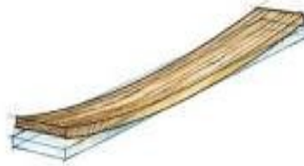
Gambar 3.1. Kayu Retak dan Melengkung
