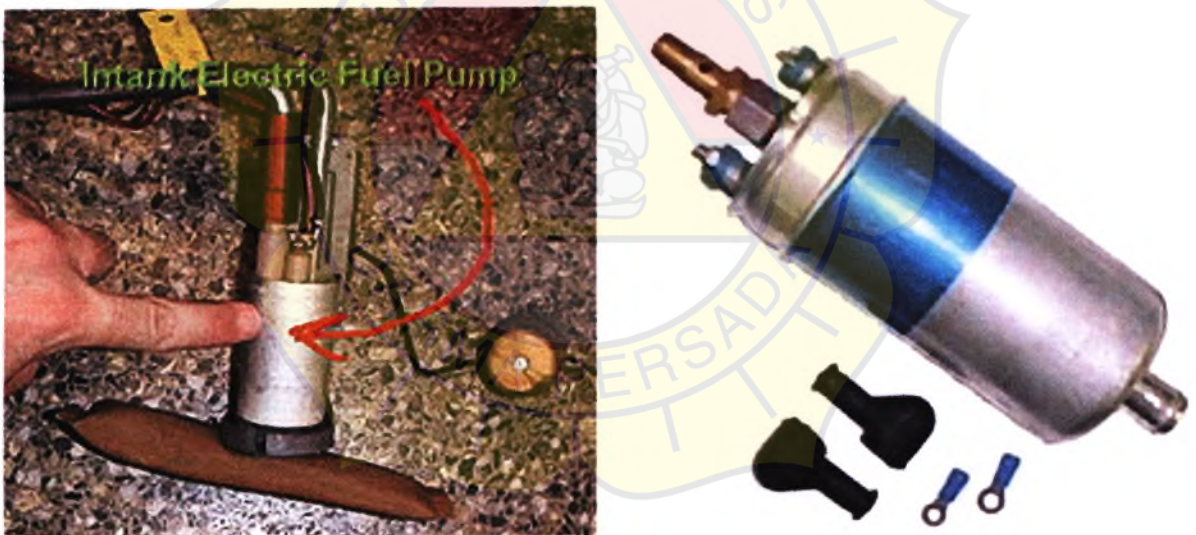
Gambar 2.6 : Fuel pump in tank (kiri) dan Fuel Pump eksternal (kanan)
