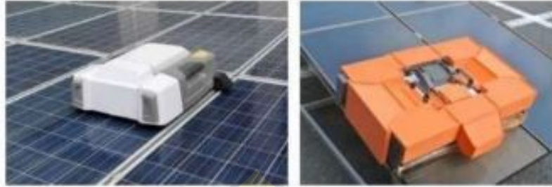
Gambar 2.4 Contoh Sistem Seluler : Raybot (Kiri) dan Miraikikai Prototipe Inc (Kanan) (Thanapon Sorndach,2018).
