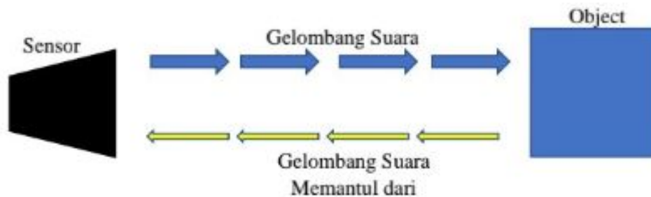
Gambar 2.10 Cara Kerja Sensor Ultrasonic .
