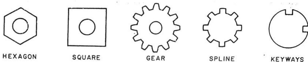
Gambar 22. Komponen mesin dengan menggunakan fixture indeks.
