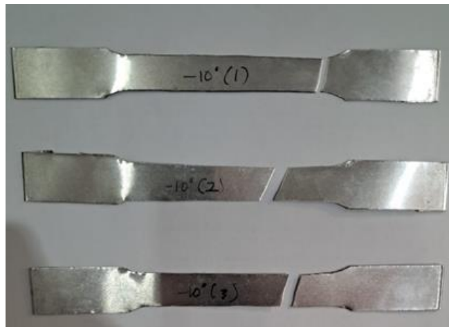
Gambar 4. 5 Hasil patahan dalam suhu -10^{\circ}\text{C} .
