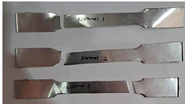
Gambar 4. 1 Hasil patahan dalam suhu normal.
