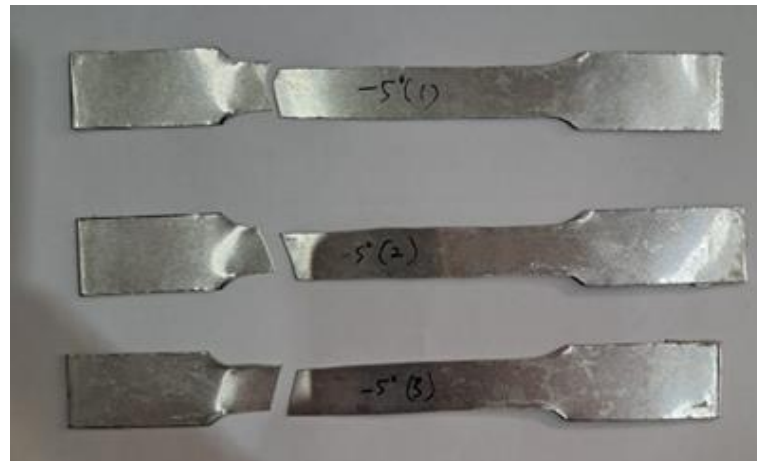
Gambar 4. 3 Hasil patahan dalam suhu -5^{\circ}\text{C} .
