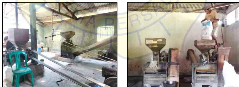
Gambar 2.7 Proses Penggilingan Gabah Menjadi Beras
