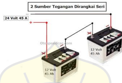
Gambar 2.11 Rangkaian Baterai Seri
