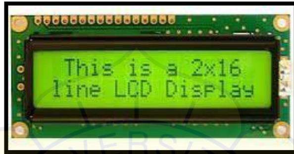
Gambar 2. 5 LCD 16x2
