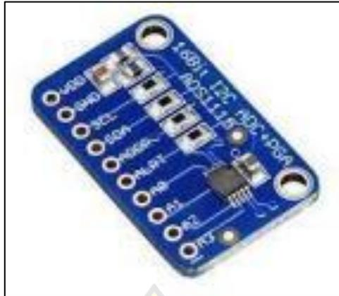
Gambar 2.7 ADS1115 Module (Setiowati, et al., 2022).
