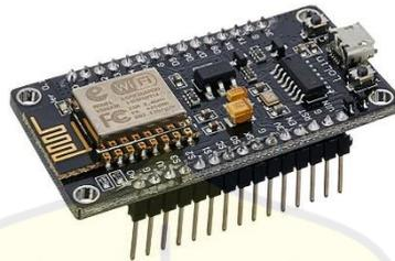
**Gambar 2. 1 ESP8266-NodeMCU**
