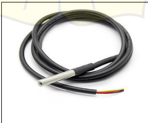
Gambar 2. 8 Sensor Suhu Tanah DS18B20
