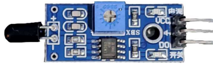
Gambar 22.1.2 Flame Sensor (Dokumen Pribadi)
