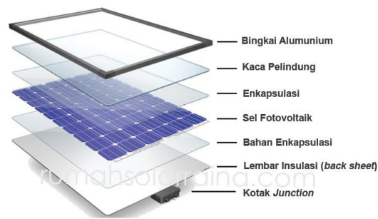
Gambar 2.1 Struktur Panel Surya.
